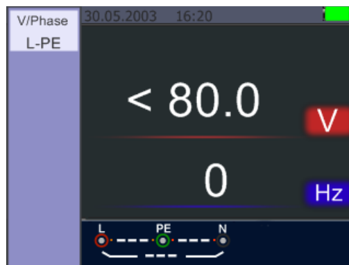
Affichage en veille de la mesure de la tension (< 80V)
